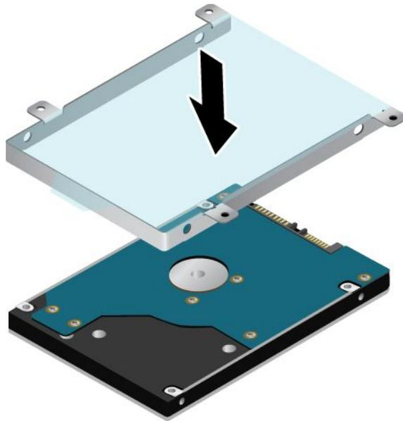
10. Drehen Sie die vier Schrauben wieder ein, um die Halterung zu befestigen.
