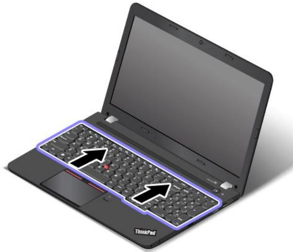
8. Entfernen Sie die Tastatur aus dem Tastaturrahmen.
