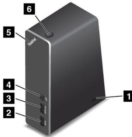
**1 Schlitz für das Sicherheitsschloss:** Um die Andockstation vor Diebstahl zu schützen, können Sie ein Sicherheitskabelschloss, z. B. ein Kensington-Schloss, erwerben, das in diesen Schlitz für das Sicherheitsschloss passt, damit Sie die Andockstation vorübergehend an einem Arbeitsplatz, Tisch oder an einem anderem nicht dauerhaften Vorrichtung verriegeln können.
