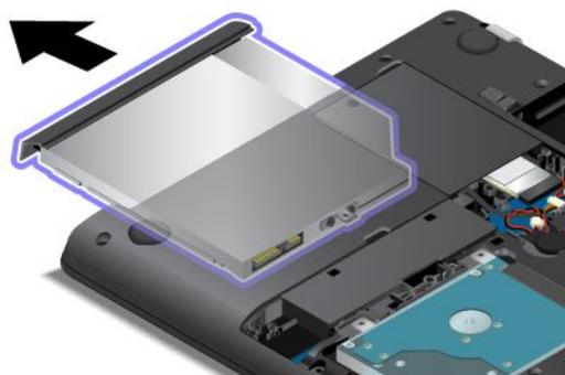
7. Setzen Sie das neue optische Laufwerk in die Position für das optische Laufwerk ein, und drücken Sie es fest in den Anschluss hinein.
