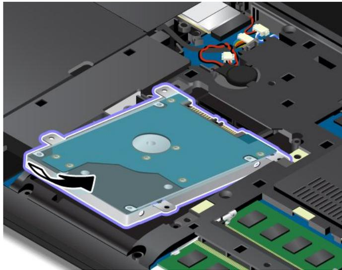
12. Schieben Sie das Speicherlaufwerk in den Laufwerksschacht hinein, bis es sicher angeschlossen ist **1**, und drehen Sie dann die Schrauben **2** wieder ein.
