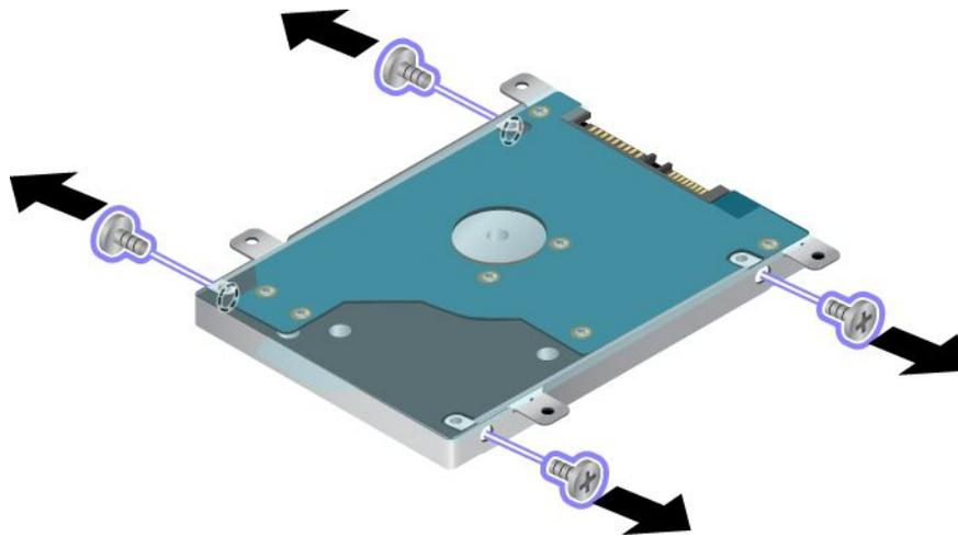
8. Entfernen Sie die Halterung vertikal vom Speicherlaufwerk.
