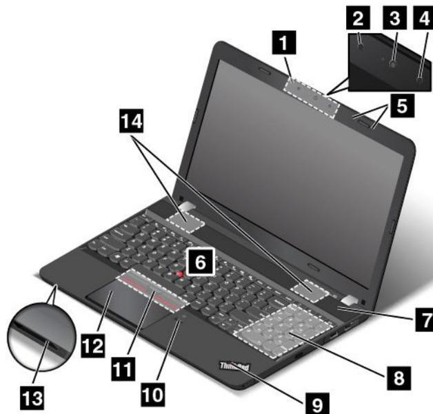
Abbildung 2. Vorderansicht bei Modellen mit einer 3D-Kamera
