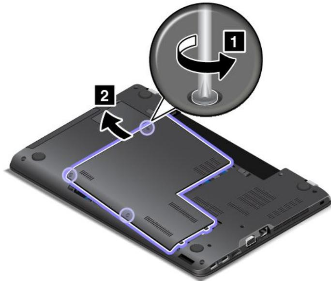
5. Entfernen Sie die Schrauben, mit denen die Tastatur gesichert ist.
