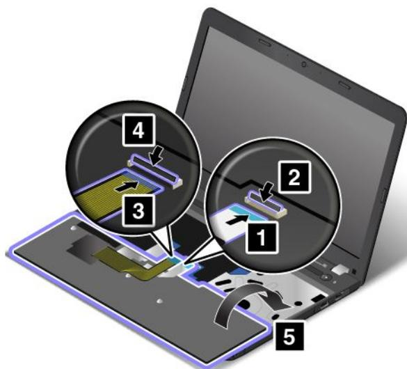
2. Setzen Sie die Tastatur ein. Stellen Sie sicher, dass sich die hintere Kante der Tastatur unter dem Rahmen befindet.
