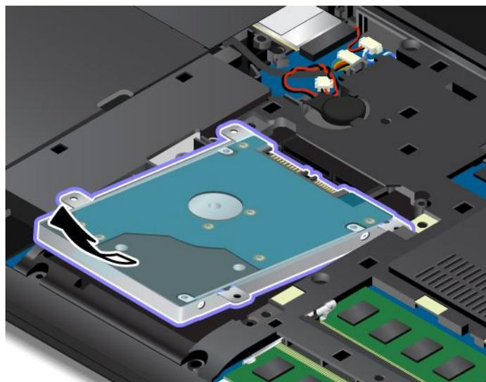
7. Entfernen Sie die vier Schrauben, mit denen die Halterung befestigt ist.
