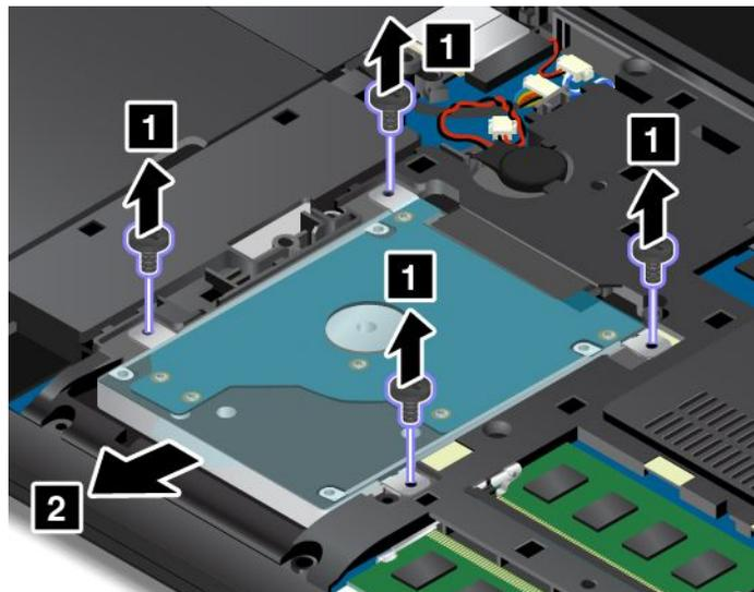
6. Heben Sie die Lasche an, um das Speicherlaufwerk aus dem Computer herauszunehmen.
