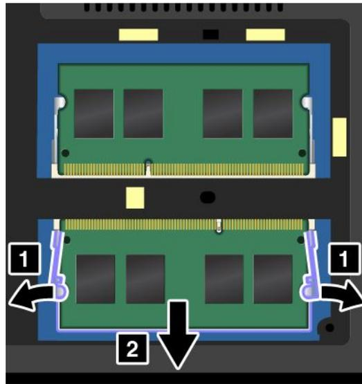
6. Setzen Sie das neue Speichermodul so ein, dass das eingekerbte Ende zur Kontaktseite des Speichersteckplatzes zeigt. Setzen Sie das Speichermodul **1** in einem Winkel von etwa 20 Grad in den Steckplatz ein. Klappen Sie das Speichermodul nach unten, bis es hörbar einrastet **2**. Stellen Sie sicher, dass das Speichermodul fest im Steckplatz installiert ist und nur schwer bewegt werden kann.
