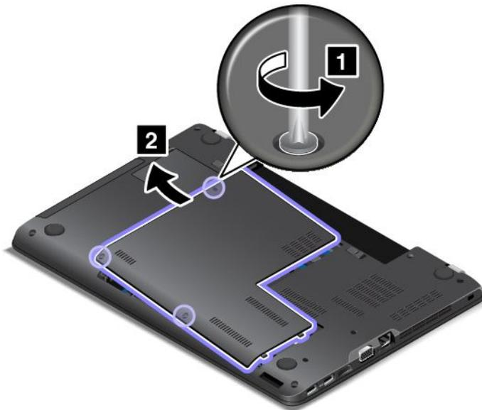
5. Entfernen Sie die Schrauben **1**, und ziehen Sie das Speicherlaufwerk heraus **2**.
