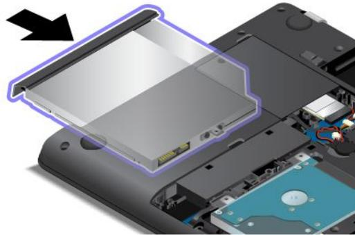
8. Bringen Sie die Schraube wieder an, um das optische Laufwerk zu befestigen.
