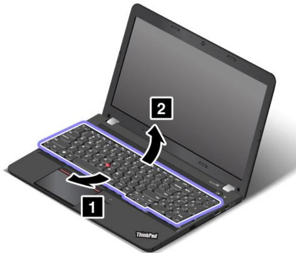
9. Ziehen Sie die Anschlüsse ab, um die Tastatur zu entfernen.
