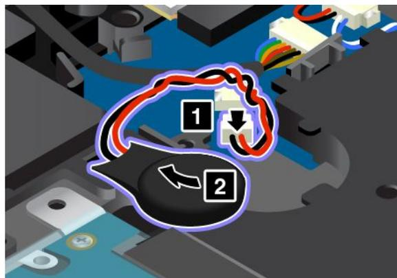
6. Setzen Sie die neue Knopfzellenbatterie **1** ein. Schließen Sie anschließend den Stecker an **2**.
