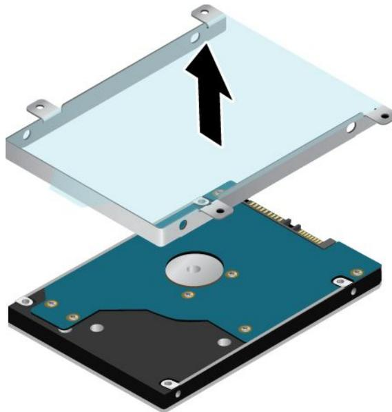
9. Installieren Sie die Halterung am neuen Speicherlaufwerk.
